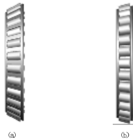
图 11 四列圆锥滚子轴承保持架结构型式
