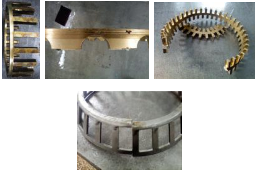
图 28 保持架磨损和断裂
