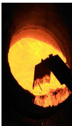
图 18 轴承钢现场扒渣前后过程
