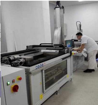
图 15 高频探伤宏观夹杂物检测
