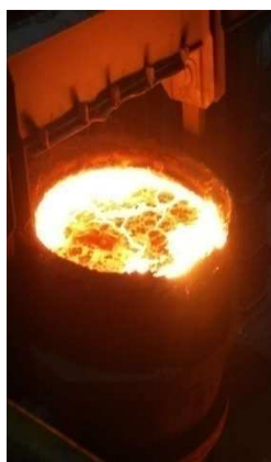
图 18 轴承钢现场扒渣前后过程
