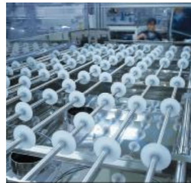
(右图: BNL 耐化学腐蚀塑料轴承应用于 LCD 屏在化学反应池中的运输)
